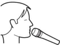
Un diagrama que muestra un perfil de una cabeza humana con un micrófono colocado muy cerca de la boca. No hay líneas de medición.                                                              | Mucho efecto de proximidad (muchos bajos/tono fundamental)<br>Sonido potente y directo                                  | Interferencias por diafonía desde fuentes de sonido contiguas muy reducidas |
